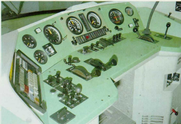
Bild 4. Und so sieht das Original-Cockpit des ICE aus, das sich auf den ersten Blick gar nicht so sehr von herkömmlichen Lok-Führerständen unterscheidet. Der Unterschied liegt auch hier im System bzw. in der Elektronik; so hat der ICE z. B. ein „DIAS“ genanntes, von MBB entwickeltes elektronisches Diagnosesystem. Vergleichbar einer Flugzeug-Elektronik überwacht und meldet dieses System vor, während und nach der Fahrt sicherheitsrelevante Daten etc. (Foto: v. Harlem)
