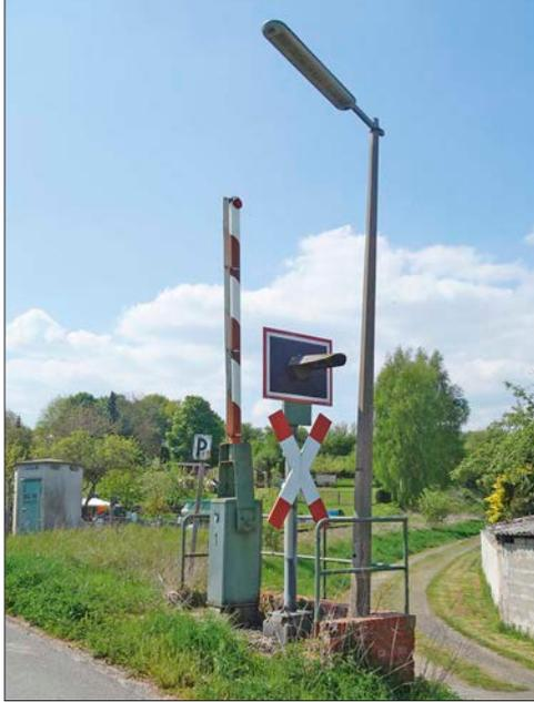
Rechts: Überwachungssignal der Bauart 1958. Nach dem Übergang der Bahnstrecke auf eine Privatbahn wurden die orangefarbenen Dauerlichter durch Reflektoren ersetzt ohne dass der Schirm modernisiert wurde. Das war aber auch nur bei nicht-bundeseigenen (NE-) Bahnen zulässig. (Die Natur erobert hier mittlerweile nicht nur das Gleis ...)
