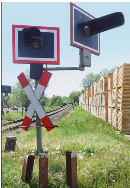
Unten: Moderne EBÜT80-Blinklichter mit „Ampel Rotlichtern“ und kurzen Schuten
