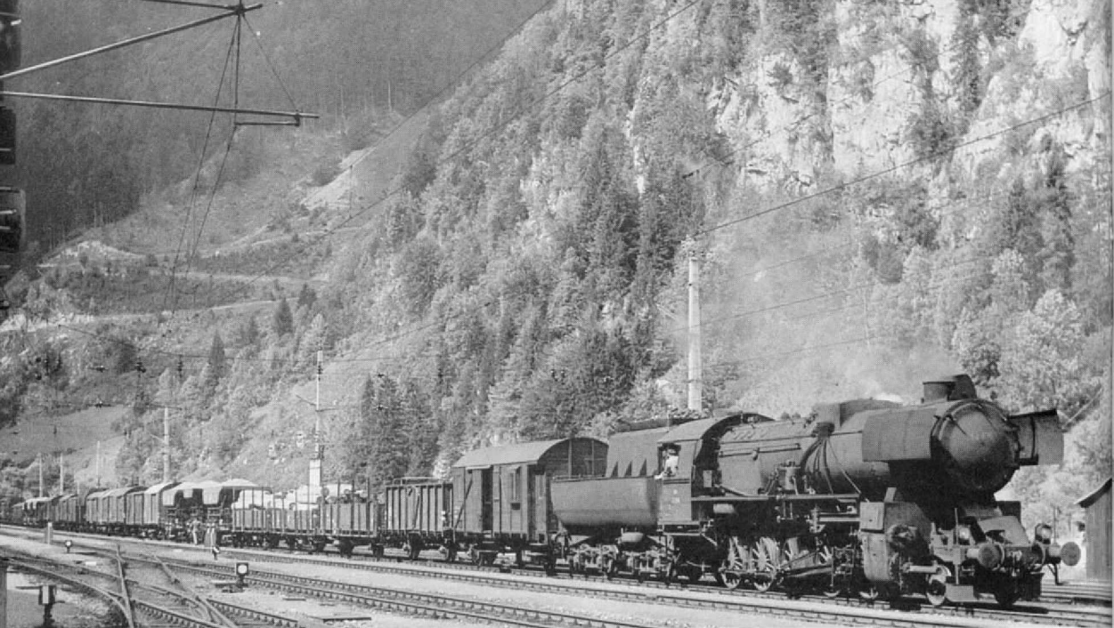
Abb. 4. Die 52.836 der ÖBB in Hieflau, ausgestattet mit Normalkamin samt Klappdeckel, Witte-Windleitblechen und Wannentender ohne Zugführerkabine – eine der Varianten, die Märklin aus seiner 50er entwickeln könnte. Weitere Möglichkeiten: BR 50 ÜK (Übergangs-Kriegslok) und die Baureihen 50 35 , 50 40 oder 52 90 der DR. Angesichts der vielen Varianten würden sich den Kleinserienherstellern zahlreiche Möglichkeiten eröffnen.
