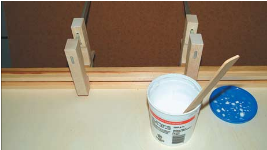
Alle Holzverbindungen wurden mit Leim erstellt. Aus Gewichtsgründen sind so gut wie keine Schrauben verwendet.
