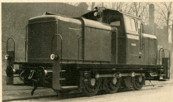
280 neue Rangier-Diesellokomotiven der Baureihe V 60 hat die DB bei der deutschen Industrie in Auftrag gegeben. Er handelt sich hierbei um eine dreischige Stelfrahmen-Lokomotive mit Blindwelle und Stangenantrieb mit halbmittig angeordnetem Führerhaus. Technische Daten: 650 PS-Dieselmotor, Flüssigkeitstriebwerke mit mechanischem Nockenstellgetriebe für Vorwärts- und Rückwärtsfahren und zur Einstellung der Geschwindigkeiten von 30 oder 40 km/h, Länge 18,5 m, Breite 3,1 m, Achsdruck 16 t, Gesamtgewicht 48 t. Ein ausführlicher Bericht über dieses neue Triebfahrzeug folgt.
