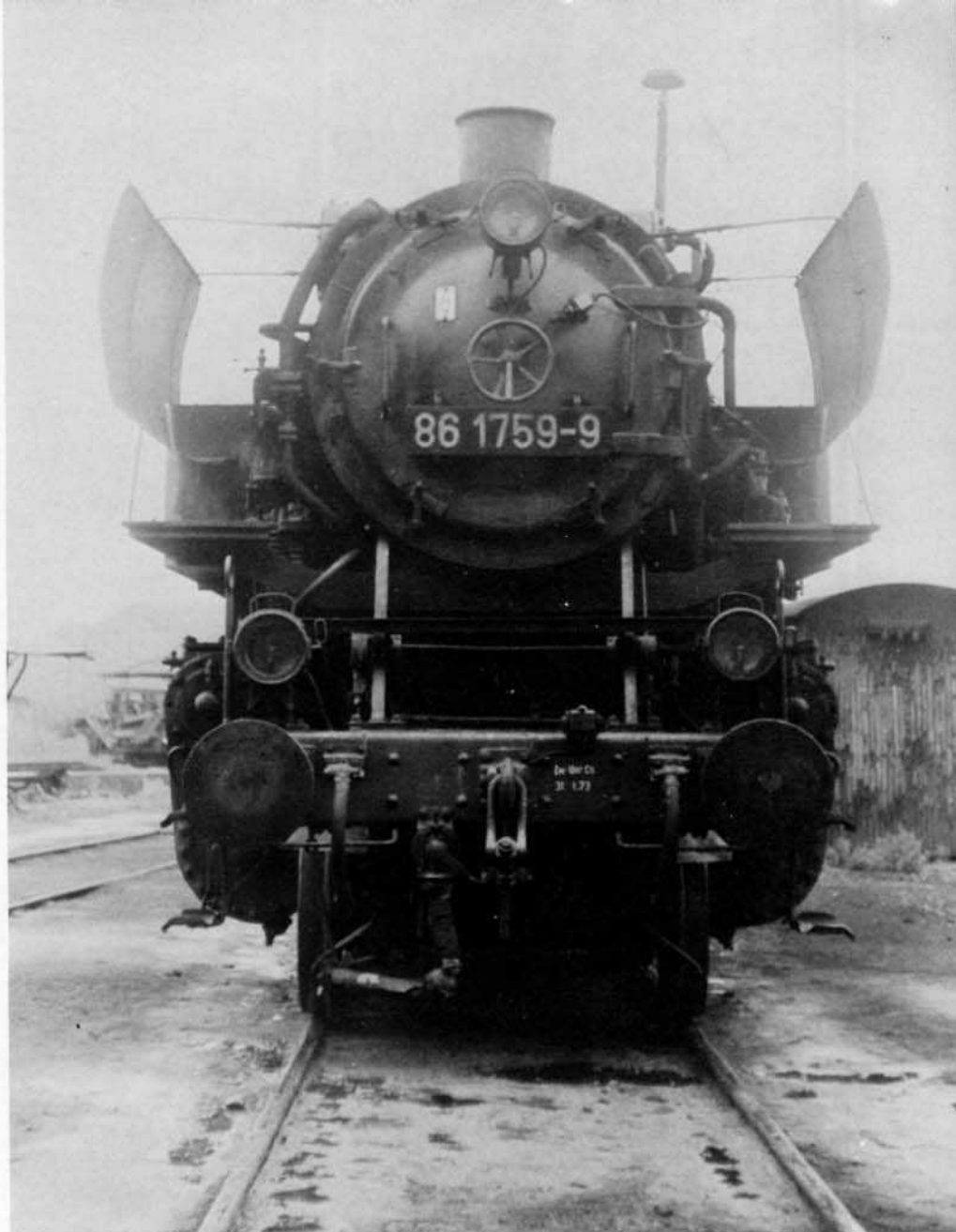
Bild 3: Die 86 1759-9 mit Witte-Windleitblechen. Dieses Erscheinungsbild war typisch für die Usedom 86er. Die Pufferbohlen-Aufschrift Zw.Unt.Cs 31. 1. 73 ließ damals noch nicht erkennen, daß bereits ein Jahr später das unerbitterliche „Aus“ für die Maschine kam.
