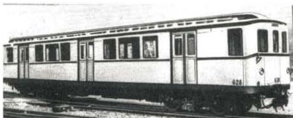
Bild 8 Triebwagen Nr. 628, Großprofil-Langwagen, 18 m lang
