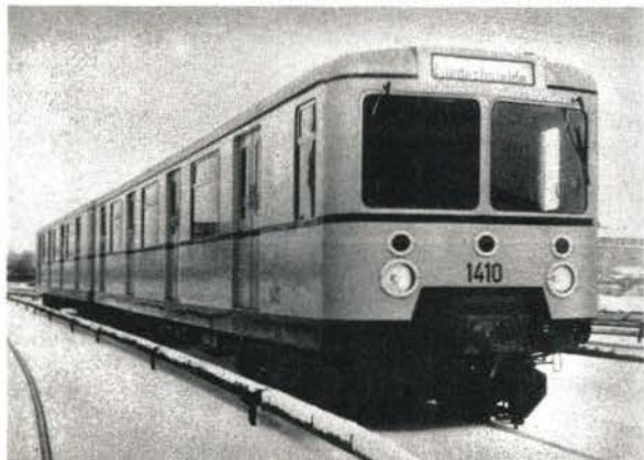
Bild 9 Triebwagen 1410 mit Beiwagen. Züge dieses Typs verkehren seit 1963 auf der Linie E („Alexanderplatz“—„Friedrichsfelde“). Es sind ehemalige Berliner S-Bahn-Wagen der BR ET/EB 168 der DR.
