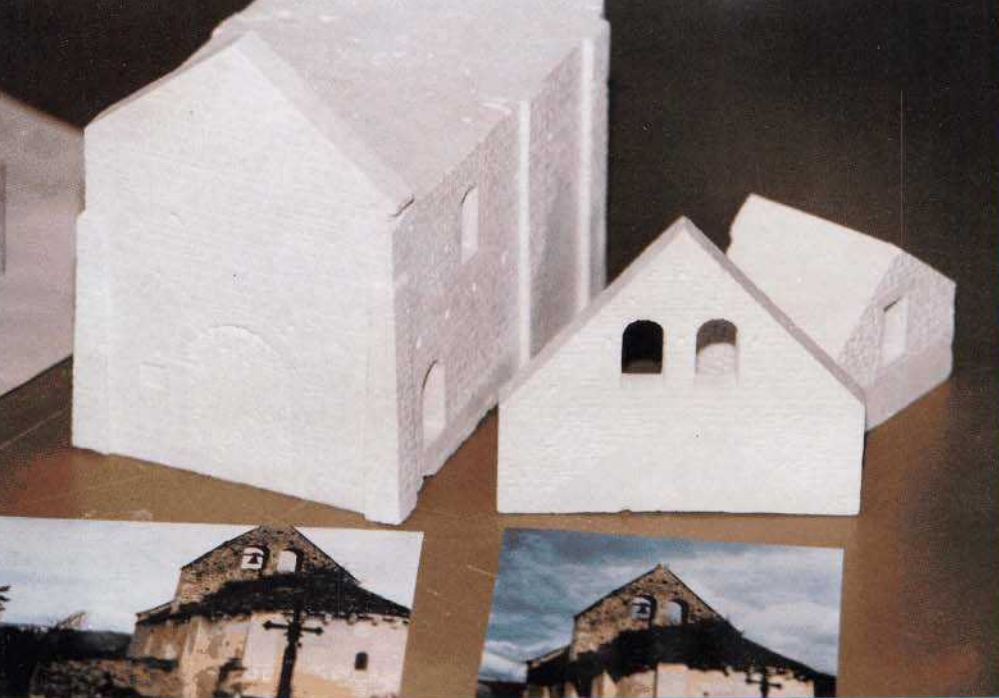
Bild 5: Die einzelnen Teile der Dorfkirche sind nach dem Gießen und Aushärten entsprechend der Vorlage graviert worden.
