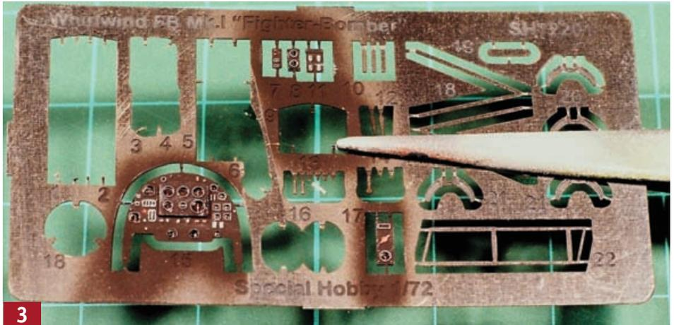
**3** Die Fotoätzteile des Armaturenbrettes sowie die rückseitig lackierten Folien mit den sehr schön gestalteten Instrumenten wurden mittels Klarlack schon auf der Platine verbunden.
