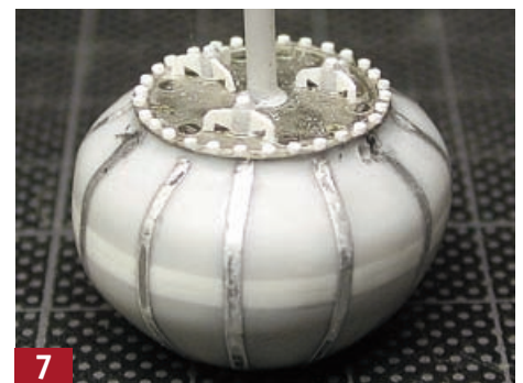
Der Schockabsorber/Airbag! Nach dem Einbau von zusätzlichen 4-mm-Plastikscheiben am Kugeläquator erhielt das Modell seinen optimalen Abstand zum Boden.
