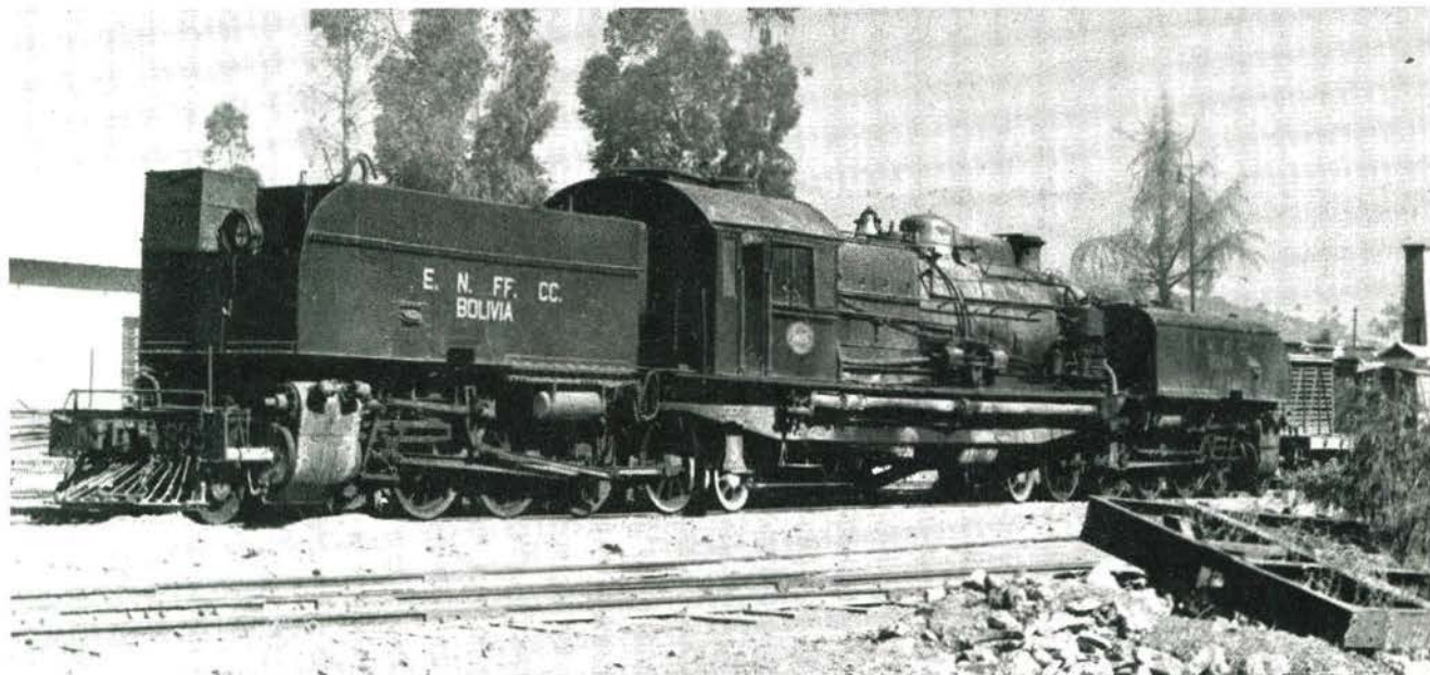
Eine meterspurige Garrattlok in Bolivien. Deutlich ist zu sehen, daß der Brückenrahmen auf das Ende des Drehgestells mit der kompletten Dampfmaschine und dem Vorratsbehälter gelagert ist.
