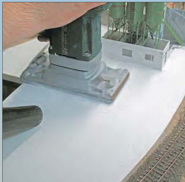
Oben: Ist die ganze Fläche gestaltet, durchgängig trocken und damit vollständig ausgehärtet, erfolgt die Glättung mit einem Schwingschleifer, ständig begleitet von einem Staubsaugerrohr, das den feinen Staub gleich aufsaugt.
