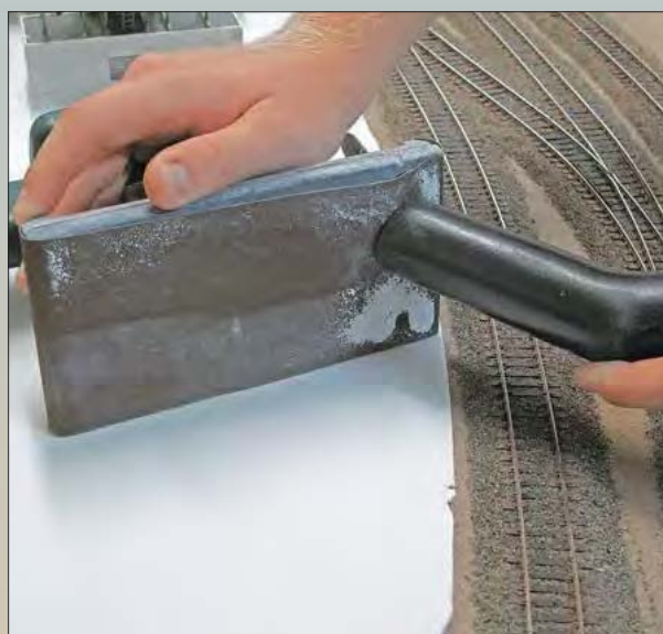
Oben: Ist die ganze Fläche gestaltet, durchgängig trocken und damit vollständig ausgehärtet, erfolgt die Glättung mit einem Schwingschleifer, ständig begleitet von einem Staubsaugerrohr, das den feinen Staub gleich aufsaugt.
