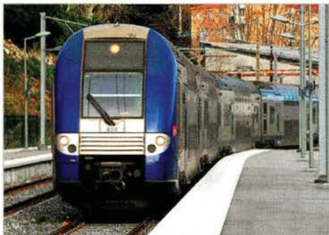
TER 2N NG: Doppelstöckiger elektrischer Coradia-Duplex-Zug, Höchstgeschwindigkeit 160 km/h.
