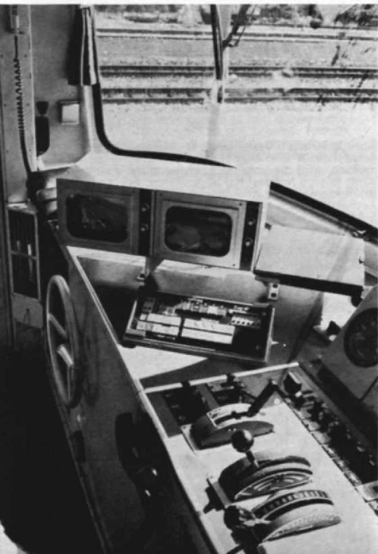
Abb. 4. Der Führerstand des ET 420 002 mit probeweise montierten Monitoren. Das kleine Pult vor den Monitoren enthält die Bedienungseinrichtungen für den Zugbahnfunk.
