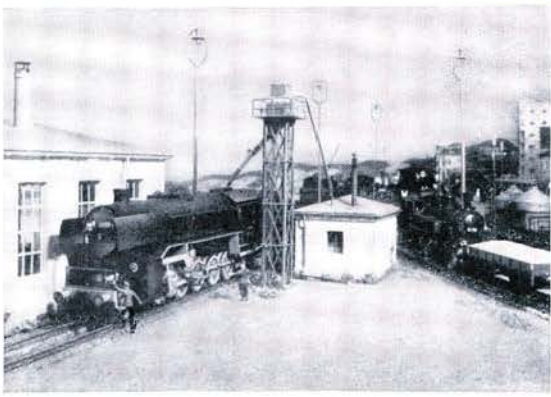
Bild 1 Güterzuglokomotive über der Schlackengrube, das Personal ist gerade im Begriff, die Rauchkammertür zu öffnen
