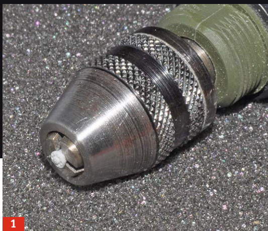
Kleine Teile fordern Zeit. Hier wird ein Deckel von zwei Millimetern Durchmesser rundgedreht
