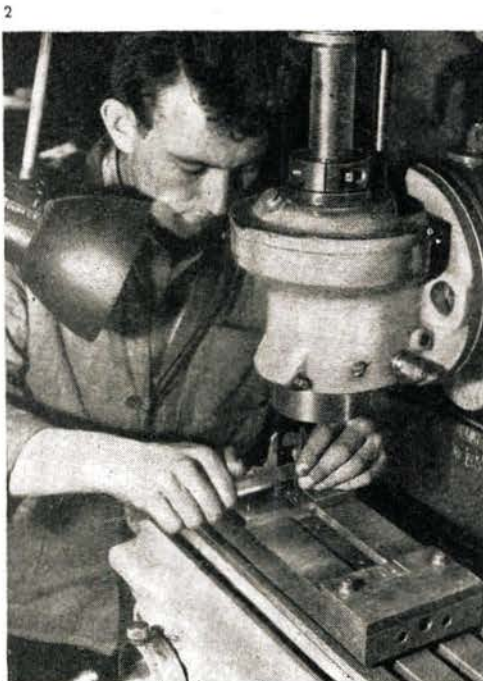
Bild 2 Mit der Graviermaschine werden die feinen Konturen der Backen ausgearbeitet.
