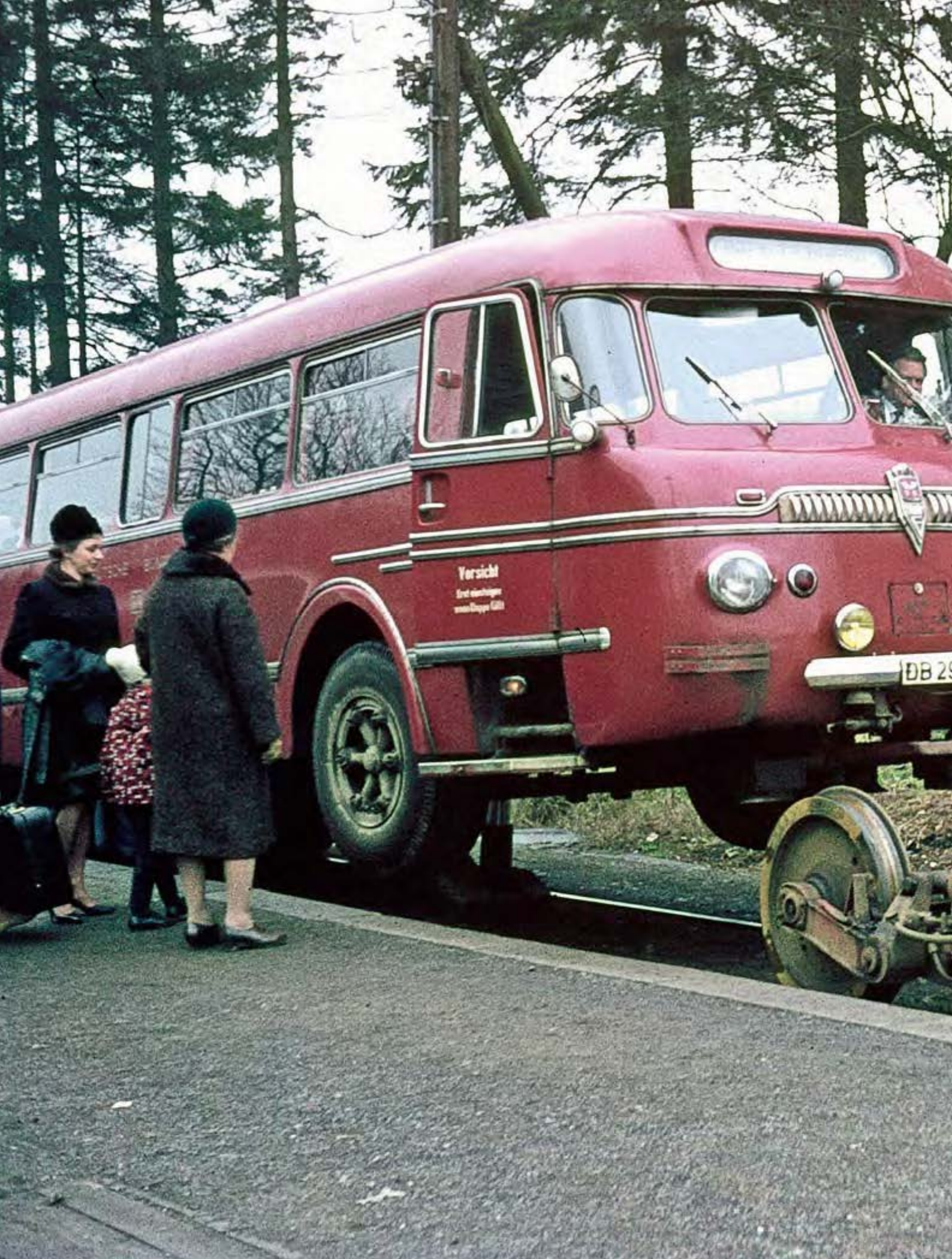
BAHN UND BUS / 3 Gänzlich vereint präsentiert sich Omnibus und Eisenbahn schließlich hier in Gestalt des Schiene-Straße-Busses. Am 9. März 1966 warten in Diersdorf im Westerwald einige wenige Fahrgäste sehnsüchtig darauf, dass die technische Bereitstellung eines jener kuriosen Vehikel vollzogen wird, um einsteigen zu können.
