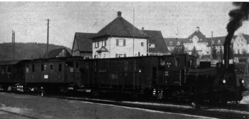
Abb. 1. Dieser Zug mit der kleinen Bn2-Tenderlok fuhr bereits in den Tagen, da der „Großvater die Großmutter nahm“, über die Strecken der Hohenzollerischen Landesbahn — die Zeit scheint stehengeblieben zu sein! Auffallend ist übrigens die überaus starke Anlehnung der Fahrzeuge an preußische Vorbilder.
