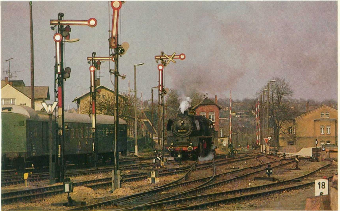
Bild 1. Signal-Anhäufung im Bahnhof Penig, in dem 50 3697-5 am 17. 4. 1982 gerade umsetzt. Von links nach rechts sind auf dem Bild zu erkennen: das im Haupttext erwähnte weiße Wartezeichen, Hauptsignale mit der Rautenkennzeichnung, diverse Weichensignale (rechts u. a. ein hochstehendes Weichensignal), Schachbrett-Tafeln zur Kennzeichnung linksstehender Formsignale, Geschwindigkeitstafeln und -anzeiger sowie Gleissperrsignale. (Foto: Volker Fröhmer)
