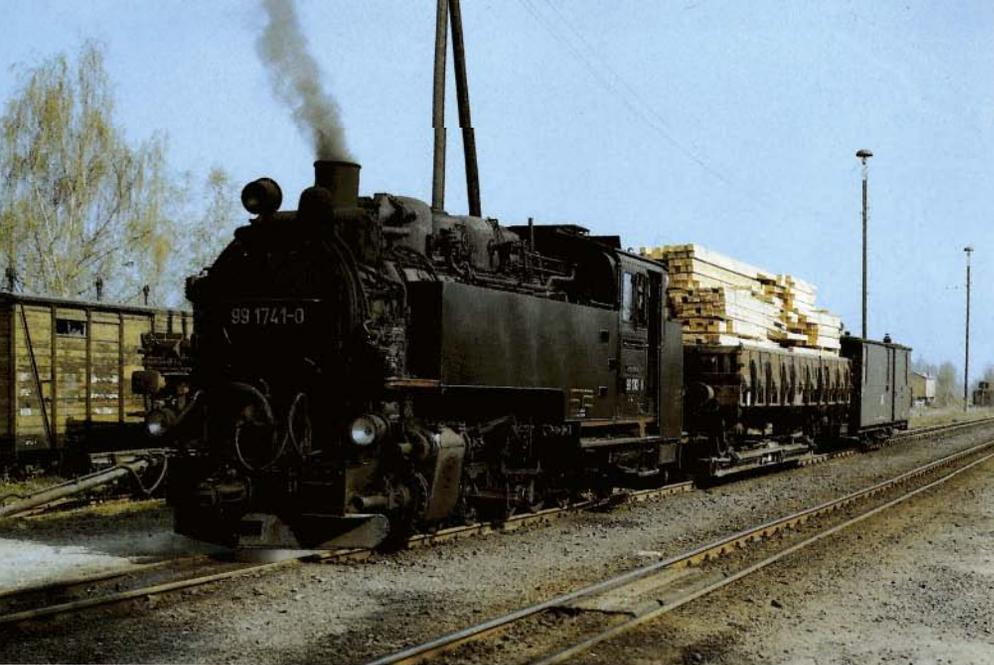
◀ **Bild 8:** Der Güterverkehr wird mit auf Rollwagen aufgesetzten Normalspurgüterwagen durchgeführt und erfolgt heute im wesentlichen auf dem Abschnitt Zittau - Oibersdorf-Oberdorf. Die 99 1741 mit einem Rollwagen und einem schmalspurigen Packwagen im Bahnhof Oibersdorf-Oberdorf im Mai 1989. Foto: M. Weisbrod
