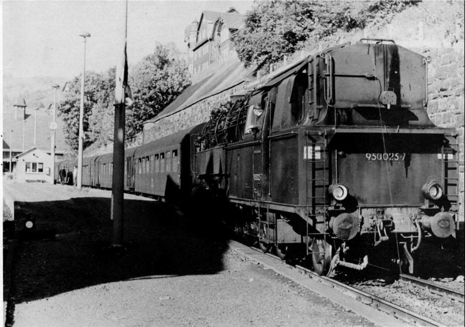
Bild 3: Dieselbe Maschine (siehe Bild 2) im Spätherbst 1978 im Spitzkehrenbahnhof Lauscha, ausfahrbereit in Richtung Saalfeld, mit Ölhauptfeuerung. Knapp ist der Platz für den Bahnhof Lauscha, und eine große Stützmauer muß den Hang abfangen.
