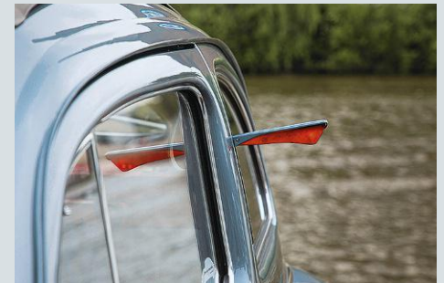
Statt Blinker zeigten noch Winker beim Ovali den Richtungswechsel an
