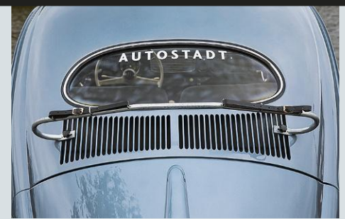
Brezel-los: Der Wegfall des Mittelstegs vergrößerte die Rückscheibe erheblich
