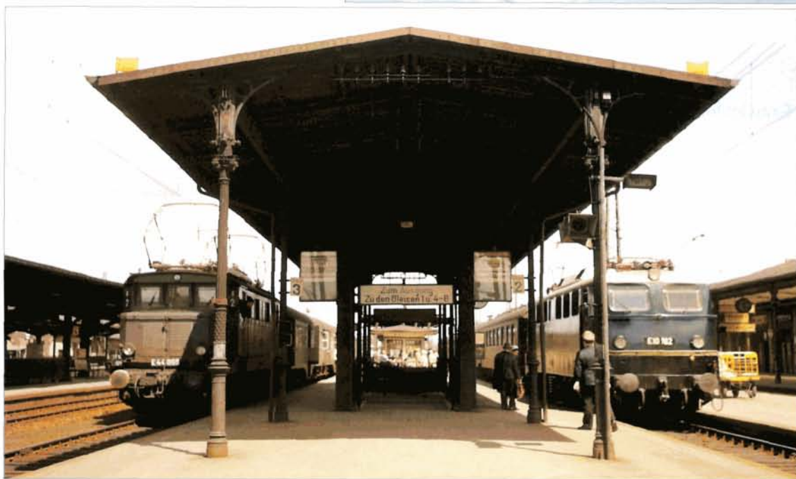
Bild 3: Die nach dem Ende des Zweiten Weltkriegs vorhandenen Fahrzeuge der Baureihen E 16, E 17 und E 18 reichten nicht aus, um den zukünftig wachsenden Bedarf an Lokomotiven für den schnellen Reisezugdienst abzudecken, und die in größerer Stückzahl vorhandenen E 44 waren mit ihrer Höchstgeschwindigkeit von 90 km/h für diesen Einsatzzweck ungeeignet. So kam es zur Entwicklung einer neuen Schnellzuglokomotive, der Baureihe E 10.
