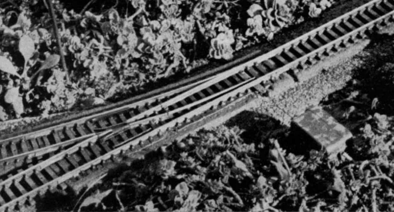
Abb. 3. Eine der im Freien installierten Fleischmann-Handweichen. Der Redlin-Antrieb ist in der rechts neben dem Gleis erkennbaren Plastikschachtel (mit Tarnanstrich) wasserdicht „verpackt“.
