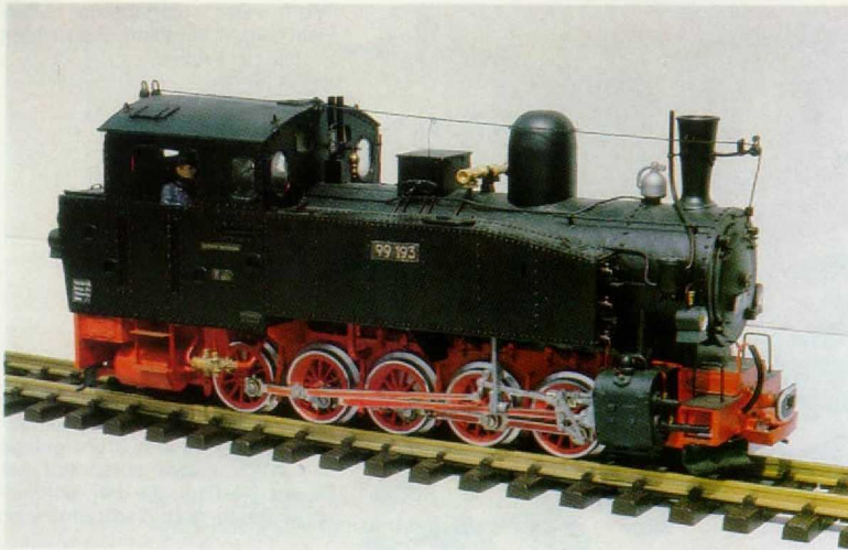
Bild 3. Der Fünfkuppler, beim Vorbild für Württemberg und Sachsen gebaut, entstand bei den Hersfelder Eisenbahnfreunden im Selbstbau; auch hier die Imitationen der Heberlein-Bremssseile etc.
