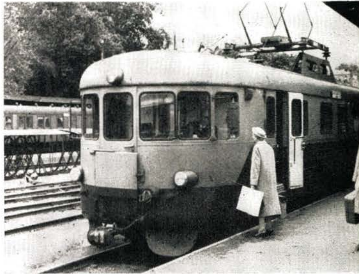
Bild 3 Elektrischer Schienenbus, 15 000 V, 16 2/3 Hz, der TGOJ
