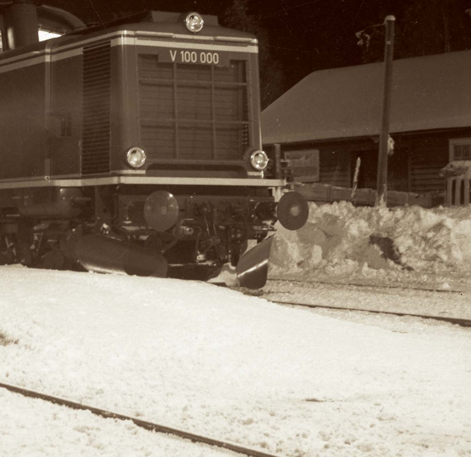
Als siebte Prototyp-V 100 hatte MaK 1958 eine eigene Vorführlok gebaut, die vom 29.12.1958 bis 11.4.1959 als „V 100 000“ in Schweden auf der Strecke Boden–Haparanda getestet wurde. Sie zeigte sich dem rauen skandinavischen Winter nicht ganz gewachsen; u.a. fror der Heizkessel ein. Im Herbst 1959 übernahm die DB die Lok als V 100 007 und noch heute ist sie bei einer Privatbahn in Italien in Betrieb. FOTO: GÖSTA BENGSSON
