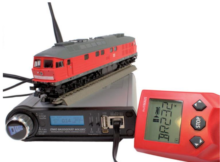
Hier kommt die Maus: Am vorderen CAN-Bus-Anschluss der MX10EC lassen sich Multimäuse von Roco und Fleischmann anschließen. Wer unbedingt will, kann auch die ältere Lokmaus 2 an diesem Anschluss betreiben.
