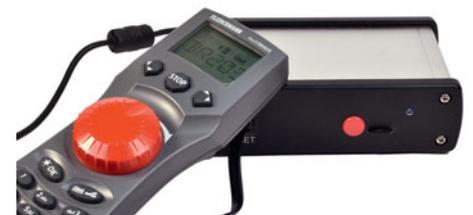
Als Handregler können Multimäuse an der Zentrale verwendet werden. Leider funktionieren im Moment Lenz-Handregler noch nicht.
