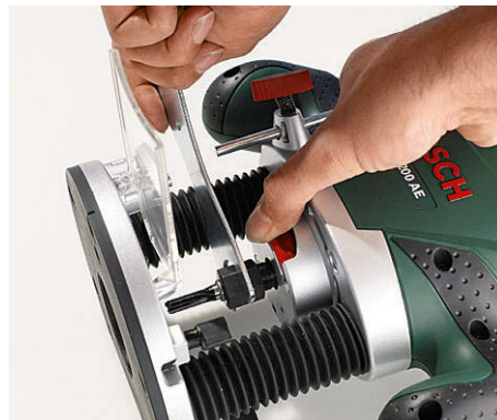
Fräserwechsel: Wie bei den meisten Oberfräsen muss bei der Bosch „POF 1200 AE“ die Spindel arretiert und geschraubt werden.
