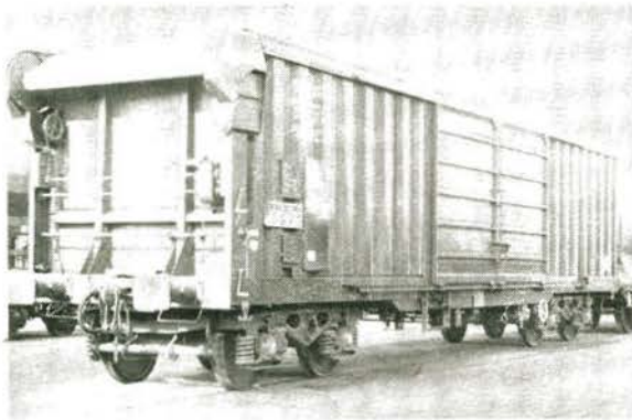
Bild 8 2achsiger gedeckter Güterwagen, Typ Hbis, beidseitig je 2 Schiebewände (Gabelstaplereinsatz begünstigend), Länge über Puffer 14 220 mm, Ladefläche 33 m 2 , Eigenmasse 14,2 t, V_{max} 100 km/h, Aussteller Waggon Union GmbH (BRD)
