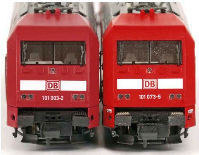
Piko: DB AG 101 003-2 in Orientrot (links) und 073-5 in Serienausführung mit verkehrsroter Lackierung
