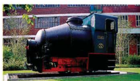
1000-mm-Dampfspeicherlok der Bayer AG. Foto: Ziegenfuß
