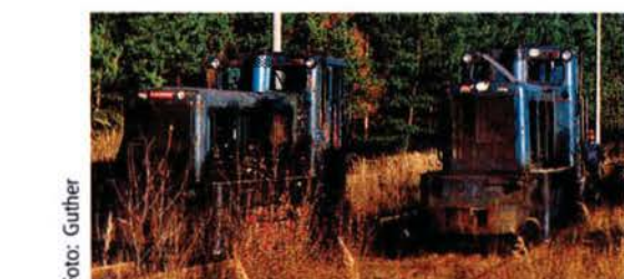
In Niederlehme verfügt ein Kalksandsteinwerk über eine eigene Werksbahn. Die dort eingesetzten Diesellokomotiven des Typs V 10 C, Baujahr 1964, stammen aus der Produktion des Lokomotivbau Babelsberg. Die Bahn soll 1996 stillgelegt werden.
