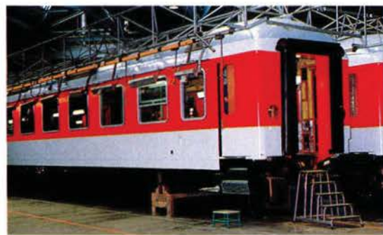
Liegewagen beim Umbau im Werk Weiden der Firma Partner für Fahrzeugausstattung.
