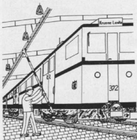
Abb. 12. Und so erfolgt die Stromentnahme. (Skizze Stahn)
