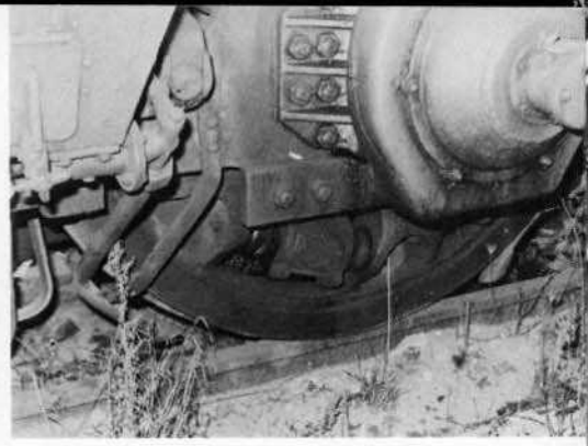
Bild 8: Zeigt das mächtige Rad mit Federtopfantrieb der E 04.
