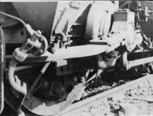
Bild 6: Zeigt die außenliegende Anlenkung der ersten Treibachse zur Vorlaufdeichsel bzw. Vorlaufachse.
