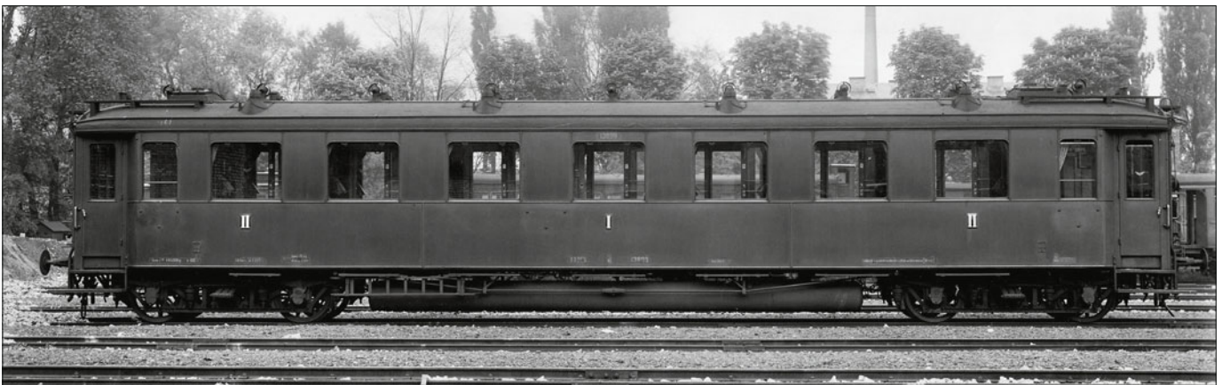
Schnellzugwagen Baden 13898 ABBü mit grauem Dach, grünem Wagenkasten und grünen Drehgestellen (Werkfoto 1907 Heidelberg)
