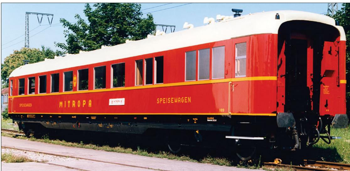
Ein vom ISG/DSG-Werk Neuaubing vorbildlich restaurierter Speisewagen der Mitropa, der äußerlich soweit wie möglich in sein Erscheinungsbild zur Zeit der Lieferung versetzt worden ist; die technische Ausstattung (Klimaanlage, Kücheneinrichtung) entspricht heutigen Ansprüchen (Foto Neuaubing 1992 Thomas Landwehr)
