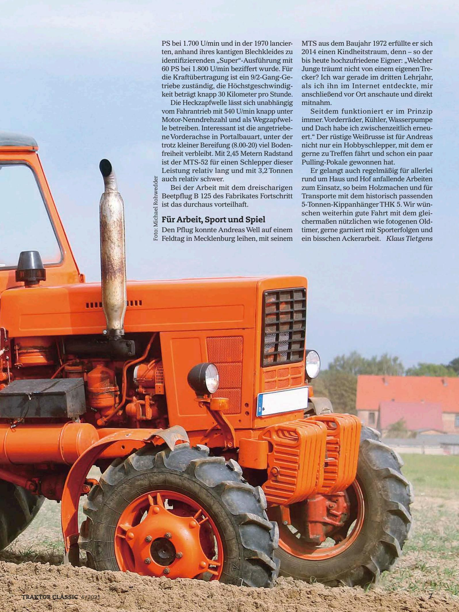
PS bei 1.700 U/min und in der 1970 lancierten, anhand ihres kantigen Blechkleides zu identifizierenden „Super“-Ausführung mit 60 PS bei 1.800 U/min beziffert wurde. Für die Kraftübertragung ist ein 9/2-Gang-Getriebe zuständig, die Höchstgeschwindigkeit beträgt knapp 30 Kilometer pro Stunde.
