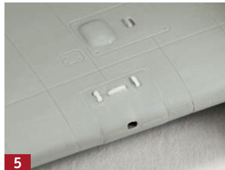
5 Nach der Behandlung mit Feile und Schleifpapier sieht die zu dicke Wartungsklappe viel besser aus. Die Umrisse wurden nachgegraviert, die Details rekonstruiert.
