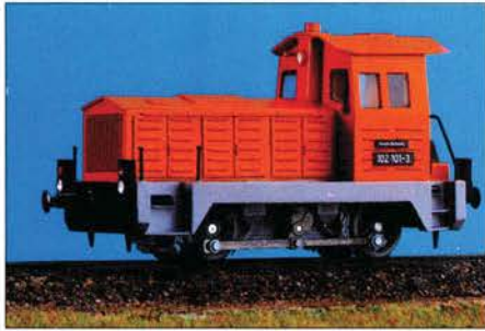
BR 102 der DR in H0 von Pmt: Aus Metall besteht das mit Glockenankermotor angetriebene Fahrzeug des Brandenburger Kleinserienherstellers. In TT wurde das Modell einer V 15 als Neuheit vorgestellt. Auch ein Schmalspur-Ski im Maßstab 1:87 war zu sehen.
