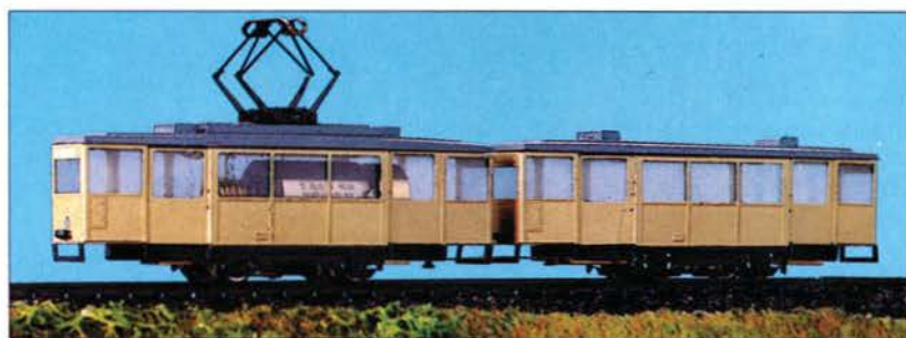
Straßenbahn in N von SB-MODELLBAU: In Messinggätztechnik wird dieses Kleinserienmodell gefertigt. Der Antrieb erfolgt mit einem Glockenankermotor. Das Fahrzeug wird es nur als Fertigmodell geben. Das Programm von Umbau- und Umrüstsätzen auf Glockenankermotoren wurde erweitert. Sie sind nun auch für viele BTTB-Fahrzeuge zu
