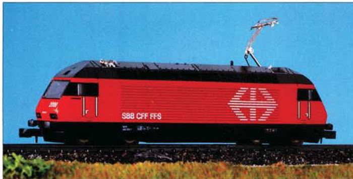
Re 4/4 460 der SBB in N von KATO: Der asiatische Hersteller produziert das neue Modell mit vier Beschriftungen. Das Metallchassis wird von einem Kunststoffgehäuse abgedeckt. Der Motor ist mit einer Schwungmasse versehen. Der „Fliegende Hamburger“ wurde in Varianten vorgestellt.
