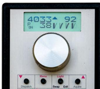
Immer vier Zubehörgeräte sind im gleichzeitigen Zugriff – entsprechend der Vierergruppierung bei den Zubehördigitaladressen. Der jeweilige Schaltzustand wird über die Weichensymbole angezeigt: Der dickere Strich steht für die gewählte Fahrtrichtung, hier also gerade, abzwiegend, abzwiegend und gerade.
