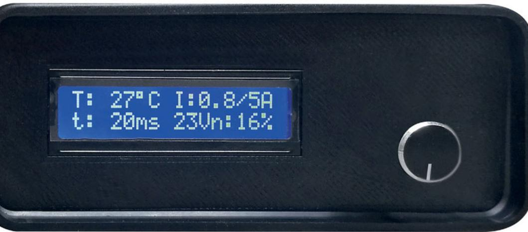
Der Booster zeigt die wichtigsten Betriebsparameter an: aktuelle Temperatur, aktueller Strom, maximaler Strom, Zeit bis zum Abschalten bei einem Kurzschluss, die Versorgungsspannung und die prozentuale Stromauslastung.
