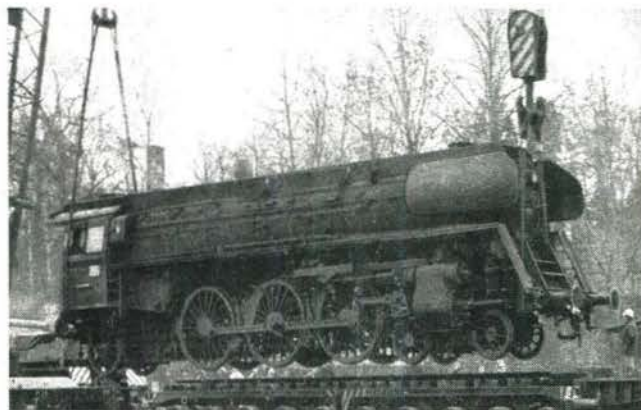
Am 22. Januar 1983 wurde die 01 0533 mit zwei EDK 1000 in Pößneck ob Bf auf einen Tieflader umgesetzt. Die Lok erhielt der VEB Thüringer Schokoladenwerk „Berggold“. Hier wird sie als Dampfspender genutzt. Der Lokstandort befindet sich unmittelbar an der Hauptstraße Pößneck—Ranis.
