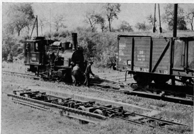
Abb. 1. Rollwagenbetrieb in natura: Im Bahnhof Mudau (Meterspur-Strecke Mosbach – Mudau) wird gerade ein beladener Rollwagen an die Schmalspurlok (Baureihe 99 72 ) angekoppelt. Im Vordergrund ein Rollwagen in Bereitstellung am Übergabegleis. Deutlich ist hier zu erkennen, daß das Rollwagengleis gegenüber dem Normalspurgleis vertieft ist. Nur bei genauerem Hinsehen erkennbar: Das Normalspurgleis ist ein Doppelspurgleis. Die sichtbare vordere Schiene gehört zur Schmalspur, während die vordere Normalspurschiene fast vollständig vom Gras verdeckt wird. (Foto: Schmidt, Nürnberg)
