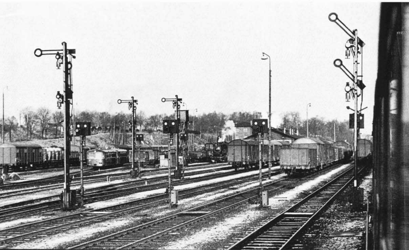
Bild 2: Ein Blick aus dem D 146 auf die Ausfahrtsignalgruppe am südöstlichen Bahnhofsende. Die Signale gelten für Züge Richtung Wiesau und Kirchenlaibach. Am 27.12.1967 wartet eine zweiteilige VT 95 — Garnitur auf ihren nächsten Einsatz, während in der Bildmitte eine 64er rangiert.
