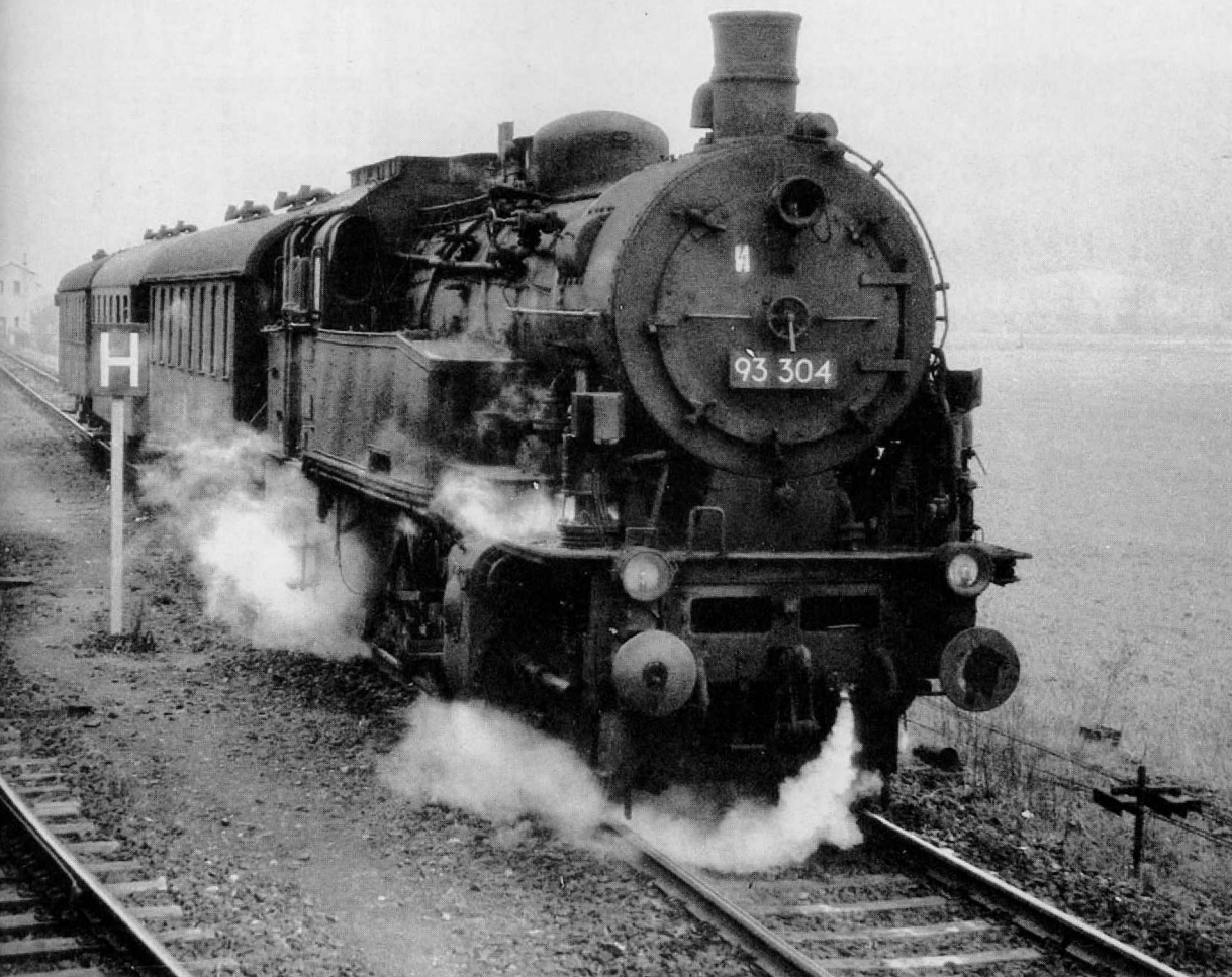
Abb. 15. So dampfte sie jahrzehntelang über Haupt- und vor allem Nebenstrecken Deutschlands: die 93 0-4 (pr. T 14), die wir hier als 93 304 – noch mit zentralem Rauchkammer-Verschluß und Handrad – mit einer besonders typischen Garnitur aus Einheits-Personenwagen bei Orlamünde sehen. Die „93“ ist eine jener „hübsch häßlichen“ preußischen Maschinen, die als Großserien-Modell unbedingt kommen sollte! Im übrigen beachte man auf dieser Abbildung – im Hinblick auf MIBA REPORT 10 – Drahtzugleitungen und Rollenhalter sowie den runden Blechkanal rechts neben dem Gleis (Foto Abb. 15 u. 16: HES).
