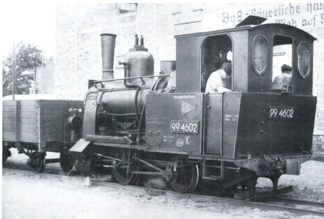
Bild 2: Die älteste aus dem Bestand der ehemaligen „Rügischen Kleinbahnen AG“ (RüKB) übernommene Lok war die spätere 99 4602 (Vulcan 1896/1560). Dieser Zweikupppler fuhr bis zu seiner Ausmusterung am 4. November 1965 in der Regel auf dem Streckenabschnitt Fährhof—Altenkirchen. Das Bild entstand ebenfalls 1955 auf dem Bahnhof Wieck.
