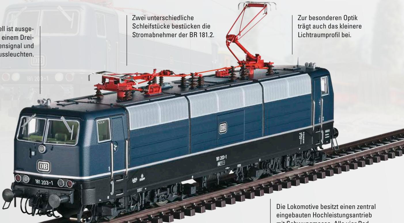
Die Lokomotive besitzt einen zentral eingebauten Hochleistungsantrieb mit Schwungmasse. Alle vier Radsätze sind über Kardan angetrieben.
