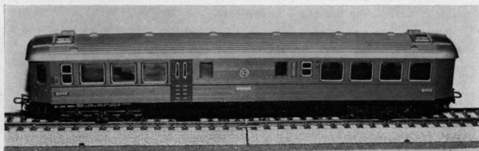
Abb. 152 u. 153. Ein schönes Modell ist auch die H0-Nachbildung des schwedischen D-Zug-Speisewagens RB 02, mit 23,7 cm Lüp (im Großen 24,1 m) nicht so stark gekürzt wie die deutschen Modelle. Das Gehäuse mit den unterschiedlichen Fensterfronten und den feinen Längsversteifungsrippen besteht aus Kunststoff. Die am einen Ende fehlende Tür entspricht dem Vorbild.
