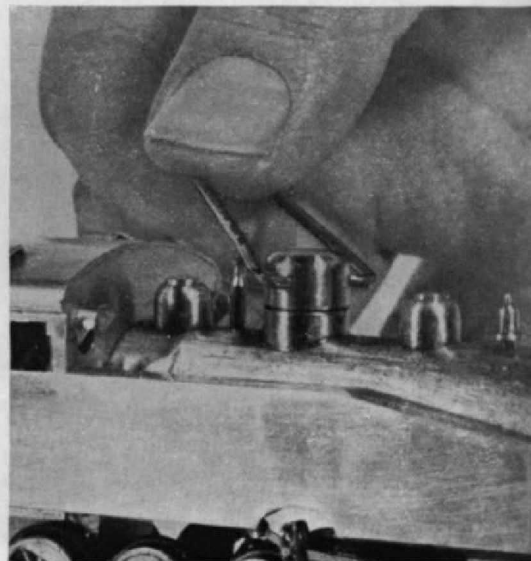
Abb. 4. Mit einem Spezialschlüssel wird der Deckel des Doms geöffnet bzw. fest verschlossen.
