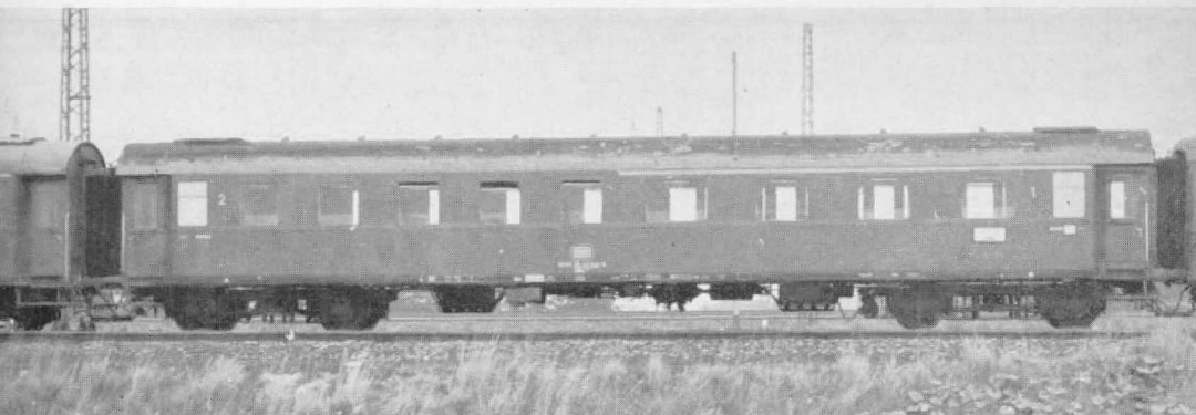
Abb. 9. Dieser ehemalige ABC 4ü gehört zu den 1933/34 gebauten, geschweißten Wagen.
