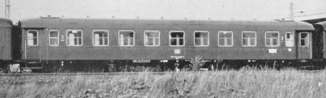
Abb. 11. Ein Sonderling im Wagenpark der DB: Dieser einstige C 4ü-35 wurde mit modernen UIC-Übersetzfenstern versehen. Zwar stehen diese auch u. E. dem Wagen nicht so recht „zu Gesicht“; aber über Geschmack läßt sich bekanntlich (nicht) streiten. Auf jeden Fall: Das seinerzeitige Liliput-Modell des 1./2. Klasse-Eilzugwagens mit Übersetzfenstern (MIBA 5/68, S. 215) kann also „guten Gewissens“ im normalen Zugbetrieb eingesetzt werden. (Foto: H. Hoyer, Hamburg)
