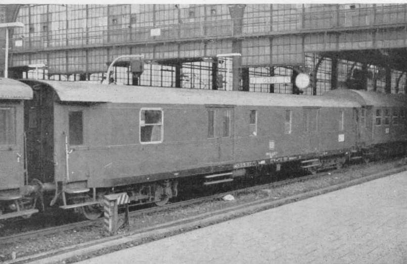
Abb. 7. Dieser Gepäckwagen der ehemaligen Gruppe 35 hatte einst eine Zugführerkanzel; das Übersetzfenster ist eine „Zutat“ der DB. Entsprechende H0-Modelle sind der Pw Post 4ü-28 und der Düe 938 von Liliput, beide ohne Zugführeraufbau. (Foto: H. Hoyer, Hamburg)
