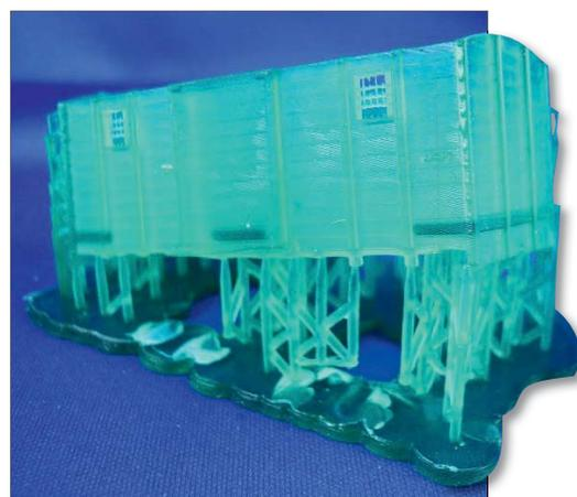
Das Resin-Modell muss von der Basisplatte getrennt und versäubert werden.
