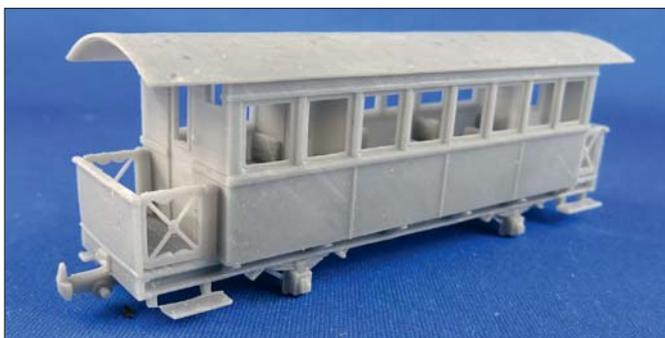
**52** Die Nachbildung eines Personenwagens im Modell ist eine durchaus anspruchsvolle Aufgabe. Mit dem 3D-Drucker kann daraus auch eine kleine Serie werden – und dank der CAD-Konstruktion lassen sich zudem kleine Bauartunterschiede berücksichtigen.
