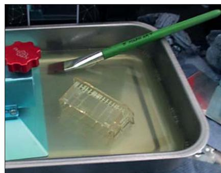
Die aus Resin gedruckten Bauteile werden mit Alkohol oder Wasser gewaschen, je nach Material.
